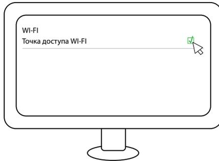
Для подключения устройств к сети Интернет через SkyTVbox, найдите созданную вами сеть в списке доступных вашему устройству (смартфон, планшет и т. д.), нажмите кнопку подключения и введите пароль, заданный в п. 11.
