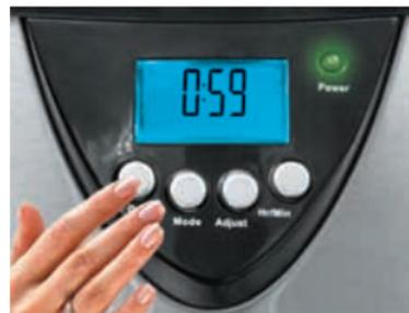
4. Чтобы прервать процесс парообразования во время работы, нажмите кнопку **ON/OFF** и удерживайте ее в течение 2-3 секунд, пока не раздастся звуковой сигнал, цвет индикатора режима работы **Power** сменится с красного на зеленый.
